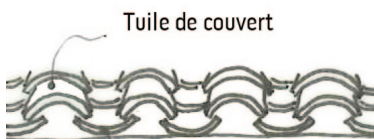
Mise en oeuvre couverture
